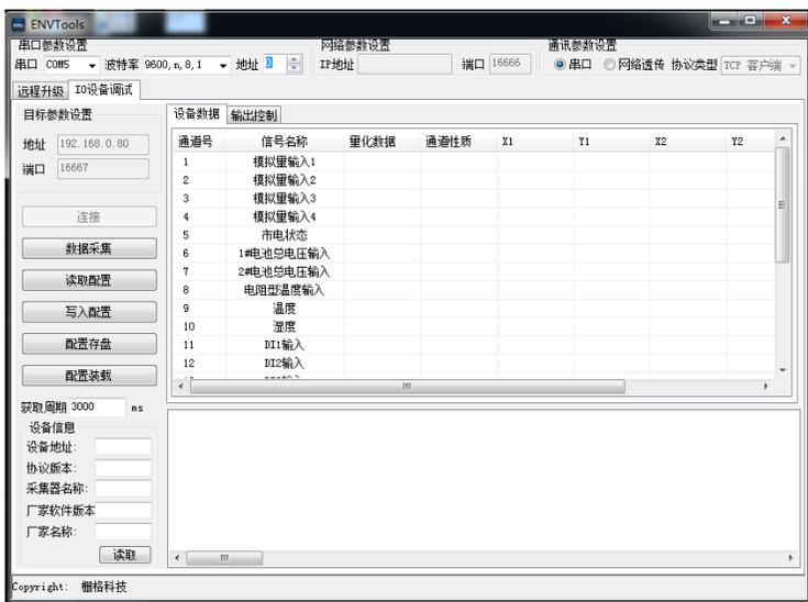
3. 再切换为“网络透传”，设置 IP 及端口号，其中“网络参数设置” IP 地址及端口设置为串口服务器中串口 5 的远端 IP 及端口号一致。
