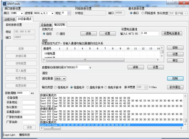
(2) 控制方式选为“自控”，再选择“遥控通道”及输出类型（高低电平，恒高电平，高电平脉冲，低电平脉冲），最后选择“控制”；再点击“数据采样”就会显示D0通道的量化数据，如下图
